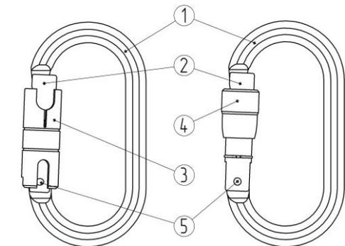
Рис. 1. 1 – скоба; 2 – защелка; 3 – автоматическая муфта; 4 – резьбовая муфта; 5 – ось.
